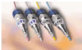
内蔵のスプリング・テンション機構によりどんなポートの深さにも自動的に対応し、キャピラリーに一定の圧力をかけ続け、デッドボリュームを生じることなく、あらゆる種類のカラムに手締めで確実に接続可。
