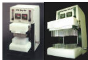
ニードルから加熱した窒素ガス又は空気を 96/384 ウェルプレートへ供給し、試料を迅速に濃縮処理。上部及び下部からの加熱ガス供給により水系溶媒の蒸発効率が向上。ガス温度及び流量は調節可。下部アセンブリの高さ可変。デュアルは 2 つのプレートの同時処理可能。
