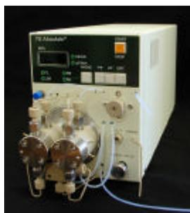
気泡・溶存ガスを自動的に除去し、これらに影響を受けない微量送液が可能。液体の持つ固有の圧縮損失を補正する機能により、補正値を入力するだけで簡単に脈流の無い高精度送液。圧力調整弁による定圧制御で安定送液。独特の機構により低沸点溶媒の安定送液が実現。
