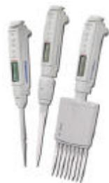
一つの制御ユニット(上半部)で異なる容量の測定部モジュールを制御可能。5 つの分注モードをプログラム可能。バッテリーはワンタッチで迅速に交換可能。簡単な操作、分かりやすい表示。左利き用の表示に切換え可能。
