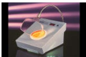
999 までのデジタルカウンターと拡大鏡付で、ガラス製又はディスポタイプの 10 cm 径標準ペトリ皿用です。加圧カウント方式で、感度が調節可。カウント毎に確認音。眼にやさしい光源を内蔵、暗背景または明背景を選択可。
