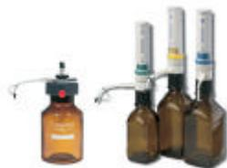
(左) コンパクトで冷蔵庫での保管も可能。プランジャー・バルブ部はボトル内で保護され、目盛柱も収納可。バルブには金属を不使用、接液部は化学的に不活性。分注容量とボトルサイズ各種用意。分解せずオートクレーブ可能。
