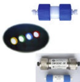
蛋白質・ペプチド・ポリヌクレオチド・酵素・DNA 等の分離に最適。低背圧でペリスタルティックポンプでも使用でき、秒オーダーでの超高速分離が可能。ポリマー合成樹脂をベースとし、ポアが貫通しているため流速に影響されず軸方向のみに流れ、チャネリングなし。
