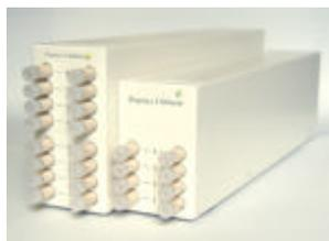
PTFEチューブに比べ200~300倍のガス拡散率を持つ Teflon AF<sup>®</sup>膜チューブを脱気モジュールに採用。内部容量は流路当り最少 200 μL です。外寸と重量が大幅に縮小され、コンパクトな設計。流路毎に独立した真空チャンバーを設け、クロスコンタミを避ける設計。
