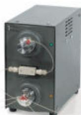
流量フィードバック制御による無脈流高精度ナノ送液。独自の高精度ナノフローセンサーのPID制御により、20 nL ~ 5 μL/分の送液を 99.5 %の高精度で。自動校正機能を備え、流量の変化に 100 ミリ秒未満の速さで反応。
