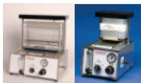
加圧による SPE 処理装置。真空マニホールド方式の欠点に対処したガスポート機構で液量が異なるカラム・ウェル間でもガスを均一に供給。使用しないカラムのポートに栓や蓋は不要で作業が手軽に。圧力の損失が無くカラムも乾燥しないため、無人処理が可能。
