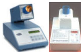
PT センサーでデジタルに温度を感知・表示。安全で簡単且つ迅速に高精度融点測定可。SMP3は温度分解能が高く、8つの温度値メモリー機能及び自動冷却装置付の高位機種。
