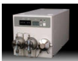
スペースをとらない小型送液用ポンプ。 $\mu$ HPLC からカラム充填用、高圧分取まで多機種。脈流の少ないデュアルプランジャータイプと汎用品シングルプランジャータイプを用意。ボールネジ駆動で安定した高精度送液。プランジャーシールの裏洗浄が可能で長寿命。
