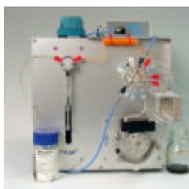
水質管理 (アンモニア・ニトリン・硝酸塩・リン酸等)、土壌サンプル分析、製薬研究、発酵モニター等に最適。FIA だけでなくシーケンシャルインジェクション分析、ピーズインジェクション分析まで可能。Windows 版ソフト FIAlab<sup>®</sup>で化学反応プロセスの全自動化が実現。
