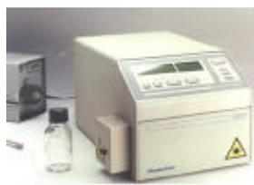
神経科学、薬理学、生化学、分子生物学、免疫学、農業、食品、環境等の分析に最適。極微量 超低濃度サンプルをピコレベルで検出可能(一般の蛍光検出器と比べて感度 50 倍)。最高感度例： $1 \times 10^{-12}$  M ローダミン 123、S/N 比 > 10、Ex：488nm。
