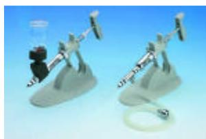
連続分注でも疲労の少ない作業。O リングなしでもプランジャーはしっかりと固定。メンテナンスフリー、洗浄・分解も簡単、分解せずオートクレーブ可能。
