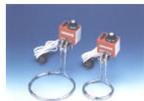
サーモスタット制御浸漬型ヒーター。どの容器と一緒に使用しても最高 300 まで温度調節可能。頑丈、確実、便利、メンテナンス不要、低価格。スターラーの機能を損なわずに加熱。
